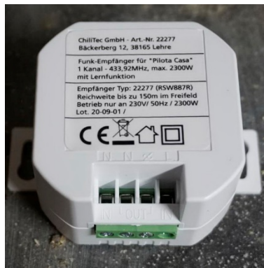
Den links abgebildeten Funkempfänger habe ich in eine Verteilerdose eingebaut
